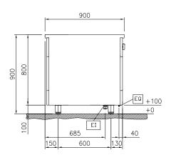
Electrical inlet (power) EQ Equipotential screw
